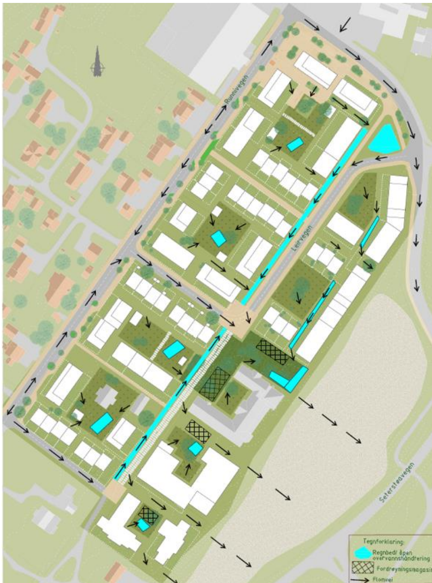
Figur 3-1 Illustrasjon som viser prinsipper for overvannshåndtering i planforslaget (fra Overvannsnotat, 10210827-RIVA-NOT-001)
